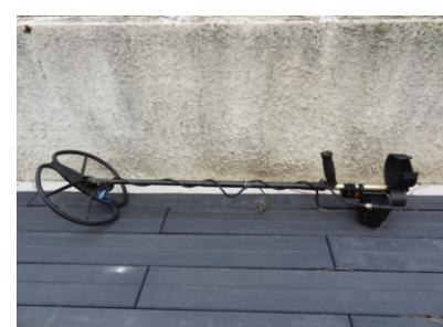
L'Ultimate33 et le boîtier du Chaser montés sur une canne carbone de fabrication perso
