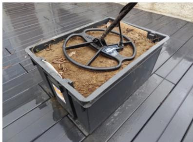
Le 1er bac rempli de 28cm de terre, une Nap3 10C est placée sous le bac
