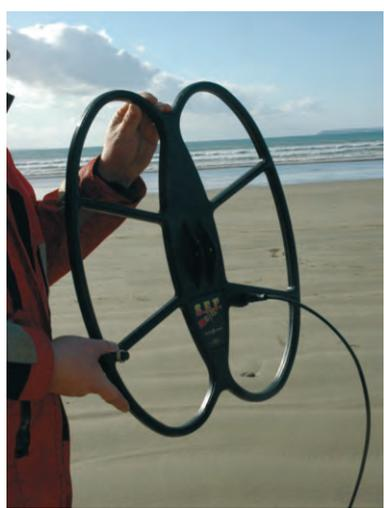
Le TDI est compatible avec les disques des GPX de Minelab et donc avec les versions SEF 45 et 53 cm . Attention cependant au diamètre de fixation des vis avec le bas de canne qui demandera aménagement à cause d'un empatement différent.
