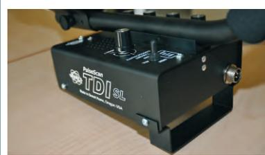
Le TDI SL dispose d'un support pour éviter le contact du boîtier avec le sable mouillé.
