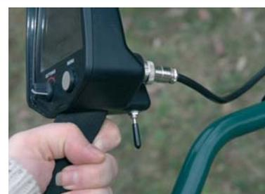
La gachette permet de régler l'effet de sol manuellement ou d'activer le pinpoint
