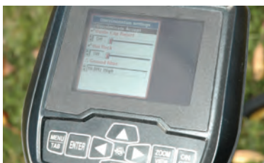
De nombreux paramètres sont ajustables pour la discrimination. Un + indique un sous-menu avec encore davantage d'options !
