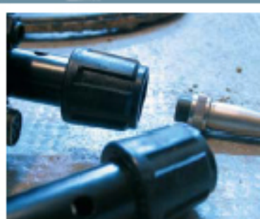
La came se démonte en 3 parties et est équipée de bagues de serrage
