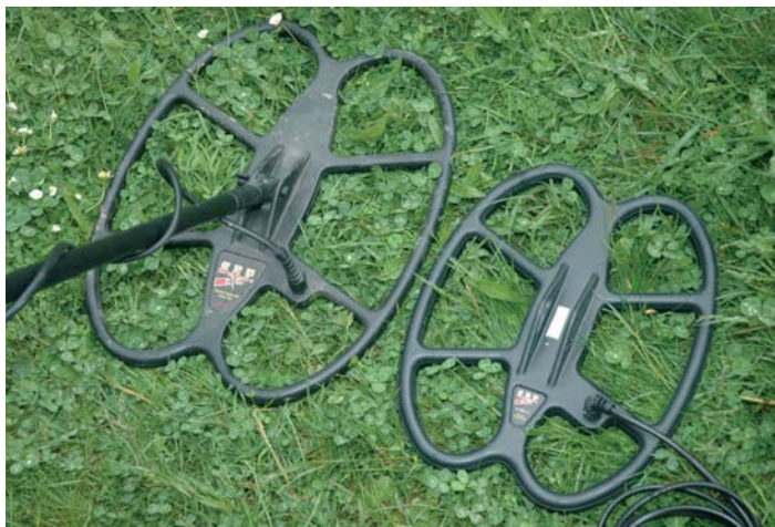
A gauche le disque de 38 cm SEF, à droite le disque de 30 cm, tous deux pour 4.6 et 18 kHz.
