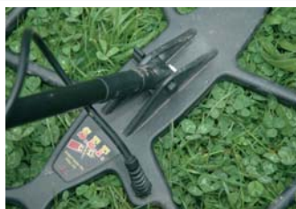
Comme sur les GOLDEN MASK, les pattes qui maintiennent le bas de canne et le disque SEF sont très larges afin de maintenir ce dernier et éviter tout faux signal lors du balayage.
