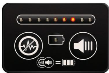
Le bouton de gauche permet de scanner les fréquences, celui de droite sert à ajuster le volume sonore. La combinaison des deux indique le niveau de la batterie. Les LED indique la force du signal correspondant à la cible détectée.
