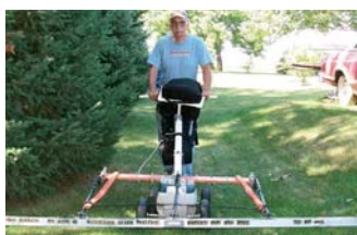
Un georadar équipé d'une antenne avec plusieurs capteurs montée sur chariot.
