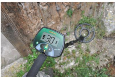
Autre point fort, l'Eurotek permet un rejet étalé du fer, une fonctionnalité d'habitude réservée aux appareils haut de gamme. Contrairement aux autres appareils de ce test qui vous donnent simplement le choix d'enlever les objets en fer ou pas, l'Eurotek dispose d'une échelle de 39 niveaux rien que pour le rejet du fer. Ceci vous permet de trouver les pointes de flèches ou carreaux d'arbalète en fer, sans pour autant exhumer les clous et autres minuscules débris de fer.
