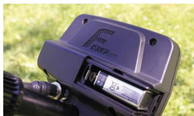
Le F11 fonctionne avec 1 pile 9V.
