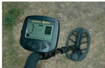
L'Alpha équipé d'un disque 27cm DD.
