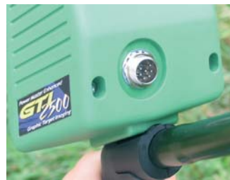
la connectique est douteuse tant au niveau des picots de connexion qu'au niveau de la visserie qui ici heurte la connexion entre le fil et le disque
