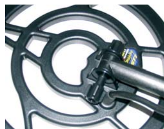
la connectique est douteuse tant au niveau des picots de connexion qu'au niveau de la visserie qui ici heurte la connexion entre le fil et le disque
