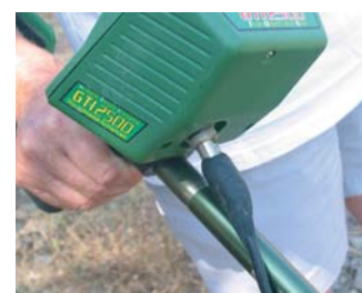
Un petit peu de gaine thermorétractable, et le tour est joué ! Vous limiterez ainsi les risques de voir votre prise casque vous rester entre les doigts
