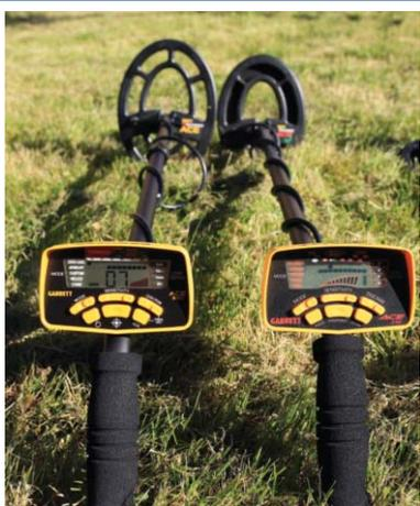
Le disque spider de l'ACE 300i mesure 25x18cm alors que celui de l'ACE 250 mesure 22x16cm. La différence de performance est minime (cf tableau test)
