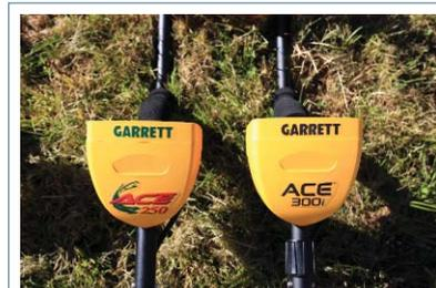
L'ACE 300i est le successeur de l'ACE 250. Sa fréquence passe de 6.5 à 8kHz, il dispose d'une disque de 25cm au lieu de 22cm et offre un décalage de fréquence.
