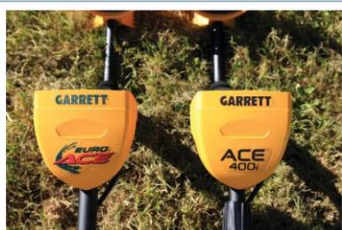
L'ACE 400i est le successeur de l'EURO ACE. Sa fréquence passe de 8kHz à 10kHz, il dispose d'une disque de 28cm DD et offre un décalage de fréquence ainsi que le très utile Iron Audio présent également sur la série AT de Garrett.
