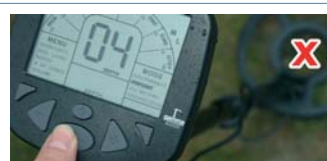
Le pinpoint visuel et sonore est très précis, la cible se trouvant toujours au centre du disque là où le son est à son paroxysme et la valeur numérique la plus basse sur l'écran.
