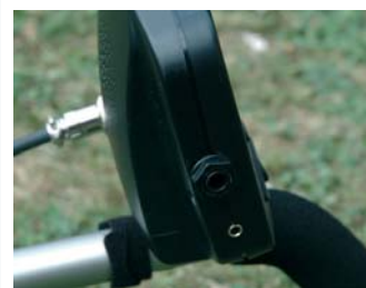
Afin d'éviter les faux-contacts liés aux adaptateurs "JACK", Teknetics équipe ses 2000/4000/6000 et 8000 des deux formats de prise. Ils permettront plus tard par la suite de brancher facilement un casque sans fil...
