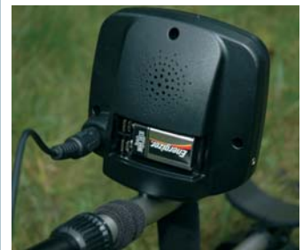
Une seule pile 9V vous donnera aux alentours de 30 heures d'autonomie. Elle s'enfiche facilement dans un compartiment protégé à l'arrière du boîtier. La connectique boîtier est d'excellente qualité puisqu'il s'agit d'une prise DIN composée de 5 contacts qui ne risquent pas de se tordre comme sur d'autres appareils que nous avons pu tester.
