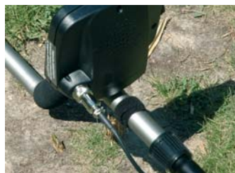
Teknetics a homogénéisé sa connectique afin que les disques soient compatibles entre eux ! On aperçoit aussi la deuxième molette de blocage.
