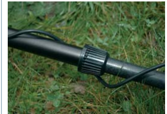
Contrairement à l'ACE 250, le GAMMA 6000 possède 2 molettes de blocage qui évitent toute vibration dans la canne au moment du balayage, rendant la détection encore plus confortable.
