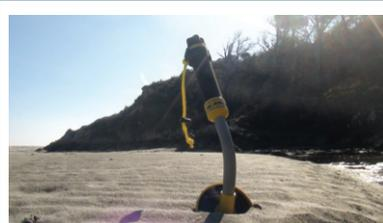
Contrairement aux Pinpointers, Bull'eye et autres Propointer conçus pour la terre intérieure, les Vibraquatic et VibraTector grâce à leur technologie à induction pulsée et leur étanchéité sont redoutables entre les cailloux, en plongée ou pour localiser une cible au fond d'un trou de sable noir avant que la marée montante ne le remplisse !
