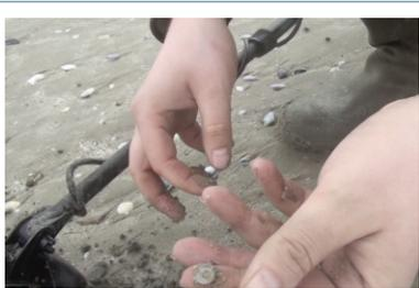
Le G2 vient de sortir un minuscule morceau de rivet de 1cm dans le sable noir donc à plus de 10 cm. C'est tout l'avantage de détecter avec un appareil haute fréquence.
