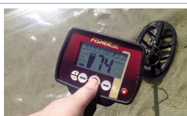
A la plage sur sable mouillé, il est impératif de choisir le disque 27cm DD et non le 27cm spider concentrique d'origine.
