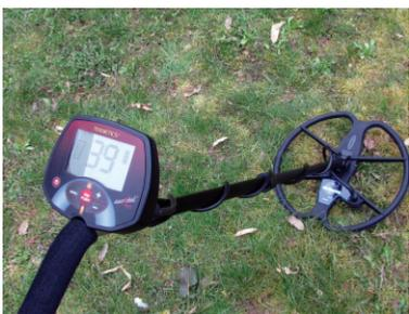
L'Eurotek PRO équipé d'un disque grand diamètre 33 cm ULTIMATE qui booste ses performances en profondeur.
