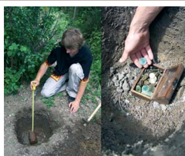
Le coffret enterré pour le test du disque.
