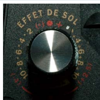
Seul le potentiomètre de réglage manuel de l'effet de sol différencie le Cibola de son grand frère le Conquérant (Vaquero)
