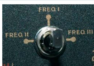
Sur les Conquérant et Cibola, vous pouvez décaler la fréquence afin d'éviter toute interférence due à la proximité d'un appareil similaire. Ceci n'a aucune incidence sur les performances vu que les fréquences sont très proches (14.3 kHz, 14.5 kHz, 14.7 kHz)
