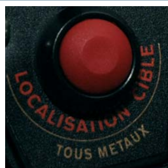
L'emploi du pinpoint, comme bien souvent avec les têtes spider, vous fera gagner du temps au début. Il permet de passer en mode tous métaux statique afin de localiser avec précision la cible qui se trouve au milieu de la "toile" du disque spider.
