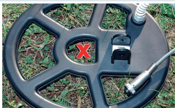
Le "X" matérialise le coeur de la toile du disque spider où le signal de la cible est à son paroxysme
