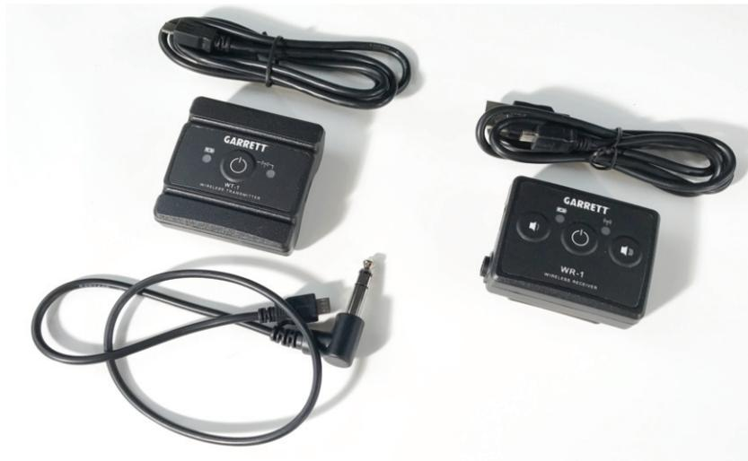
A gauche l'émetteur WT1 à droite le récepteur WR1. Tous les deux se rechargent via USB en 5 heures et offrent une autonomie de 30 heures ! L'émetteur se branche à n'importe quel détecteur pourvu d'une prise 6.5mm.
