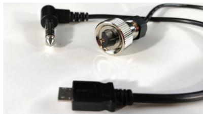
Les connectiques des émetteurs sont interchangeables sur les casques Garrett contrairement aux modèles Deteknix/Quest. Ici le le cable permettant de relier le WT1 à un AT PRO/GOLD/SEAHUNTER/ATX qui est optionnel sur le ZLYNK et offert avec le MS3
