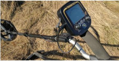
Emetteur WT1 monté sur la canne d'un G2 grâce aux élastiques fournis. La photo provient du site Hobby Detecting qui a donné une très bonne note aux ZLYNK et MS3.
