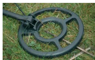
Le disque concentrique 20 cm d'origine des ALPHA/DELTA/GAMMA. Le fil arrive à l'arrière du disque. Même s'il n'est pas protégé par un capuchon, sa position derrière le disque le protège astucieusement des chocs. Les retours SAV pour ces disques sont d'ailleurs très peu nombreux.
