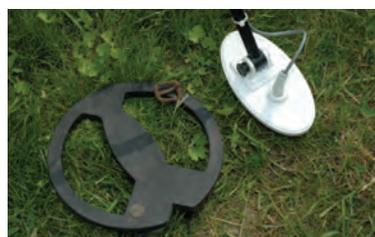
A gauche le disque 22 cm qui souffrira davantage de par son diamètre de masquage de cible du au fer s'il entre en contact avec un cible ferreuse (matérialisée par la boucle) et non ferreuse plus petite (DT en cuivre en bas du disque) au cours d'un balayage.
