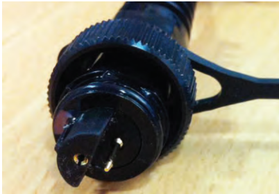
Les connecteurs étanches de l'AT PRO sont très fins, attention donc !
