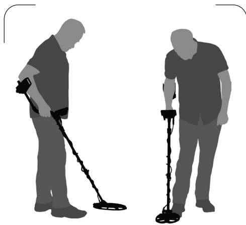
La hauteur de la canne est incorrecte
