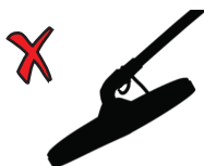
Mauvais angle du disque
