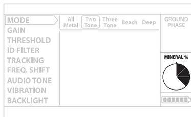
L'Indicateur de Minéralisation Magnétique se compose de huit niveaux. Au démarrage et pendant les prospections sur des sols qui ont une minéralisation magnétique faible, l'indicateur qui correspond à un diagramme circulaire reste vide. Dans les zones où le niveau de minéralisation magnétique est élevé, le niveau de l'indicateur augmente en fonction de l'intensité. Cette mesure peut être résumée comme le niveau de propriété et d'intensité magnétique du
