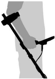
Positionner votre bras sur le repose bras et l'attacher avec la sangle. Saisissez la poignée du détecteur et reposez votre avant-bras sur le repose bras.
