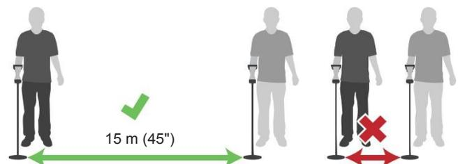
EQUINOX ne doit pas être utilisé à l'intérieur. Le métal dans les sols, les murs, ainsi que les appareils ménagers, provoqueront des interférences importantes.
