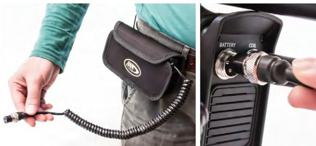
Au cas où vous souhaitez perpétuer les piles, retirez les ceintures de couverture des clichés et l'accrocher à votre ceinture. Insérez le box de la batterie dans la prise sous la zone système et le fixer en serrant.
