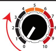
La programmation du sol doit être réglée sur « 0 » et la sensibilité à « 10 ». la recherche se fait en soulevant le disque de 5 cm du sol et en le déplaçant à droite et à gauche dans un mode parallèle. Afin d'éliminer les effets du sol, le bouton de réglage du sol doit être tourné de gauche à droite lentement, libérer le bouton quand le son s'arrête. Votre réglage du sol est terminé.
