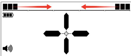
Signal de centrage faible de la cible: il y a peu de segments de discrimination activés. La cible se trouve plutôt sur le côté du disque.
