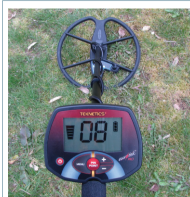
L'Eurotek pro avec un disque Ultimate 33cm. L'adjonction de ce disque permet un très net gain en performance.
