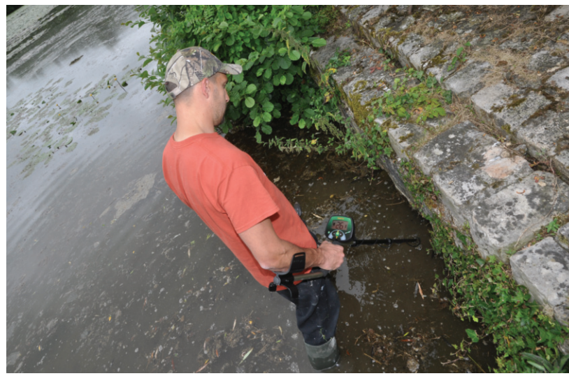
Le disque spider 20cm qui équipe les Eurotek est parfaitement étanche.
